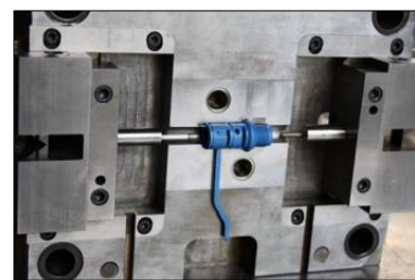
Moule d'injection pour pièce technique destinée au secteur médical.
